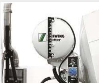
Tanque de agua a presión en aluminio (300 L / 400 L)
