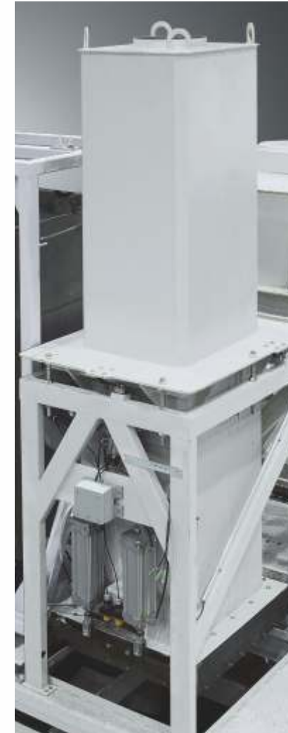
Sistema de pesaje de hielo.
