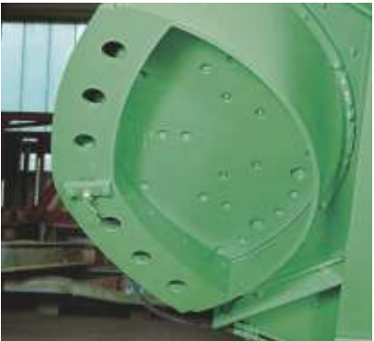
Salida de descarga de la Mezcladora, hidráulicamente activada para una rápida descarga.
