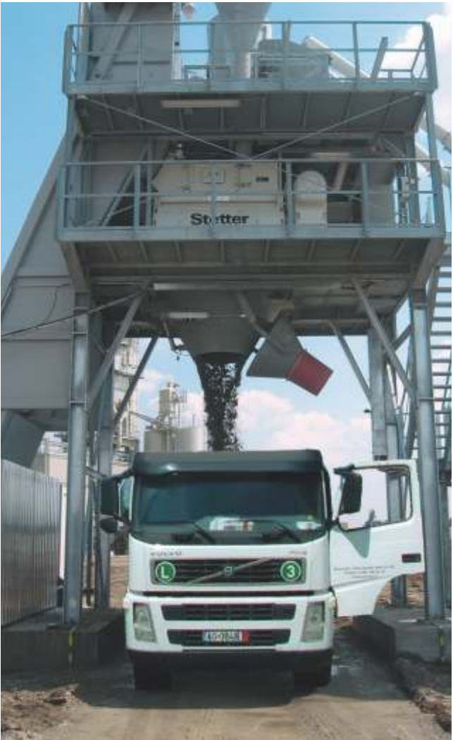
Descarga directamente en el camión.
