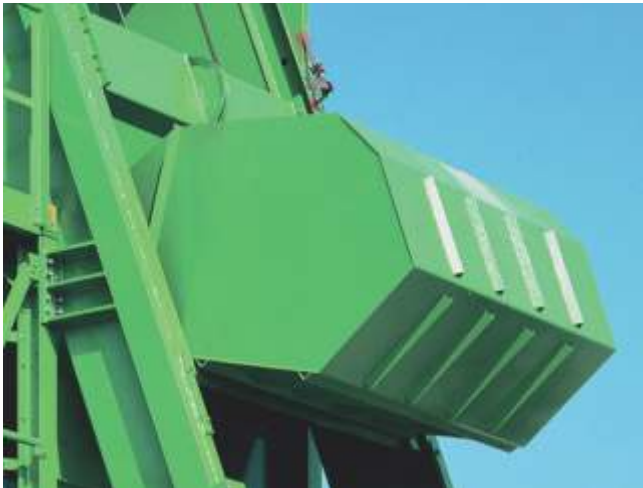
El Skip de gran dimensión con una forma optimizada garantiza total vaciado.
