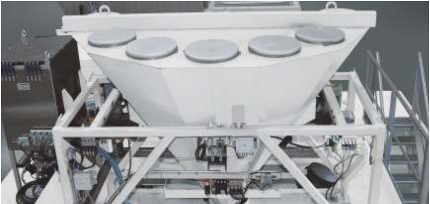
Sistema de pesaje de cemento.
