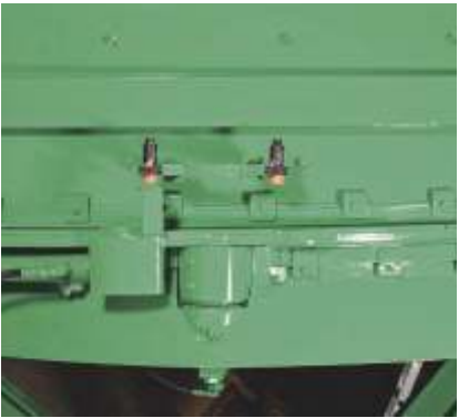
Sistema de descarga manual integrado en caso de fallas en el suministro de energía.
