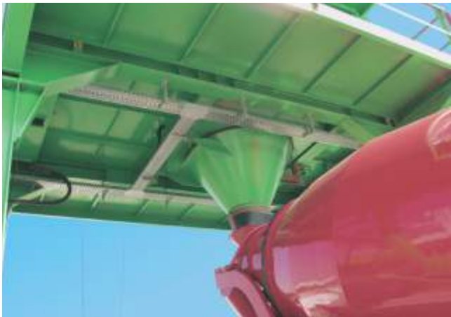
Válvula de descarga directa para la Mezcladora.
