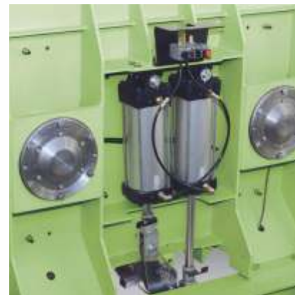
Operación neumática de salida de descarga.
