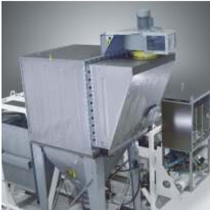
Sistema anti polvo de la Mezcladora.
