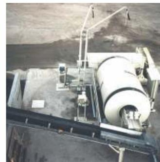
Instalação com correia transportadora de agregados residuais.
