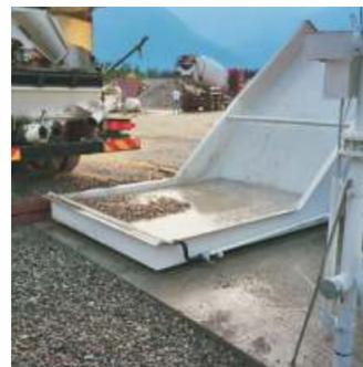
Alimentação com acionamento hidráulico para o descarregamento do concreto residual de Auto Bombas para Concreto. (1.100 litros de capacidade).
