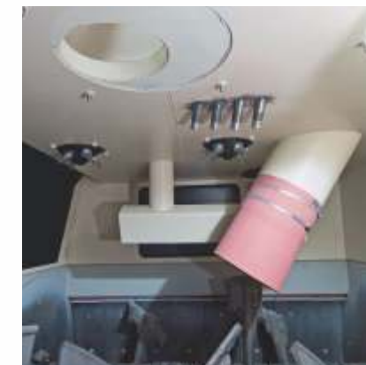
Sistema de limpeza do misturador.
