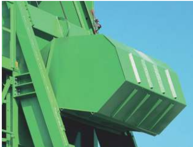
O skip de grande dimensão com uma forma otimizada garante total esvaziamento.
