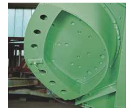
Saída de descarga do misturador, hidráulicamente ativada para uma rápida descarga.
