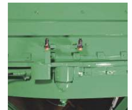
Sistema de descarga manual integrado, em caso de falhas no fornecimento de energia.
