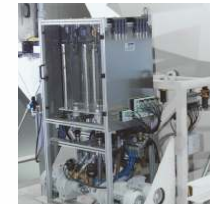
Sistema de pesagem de aditivo.
