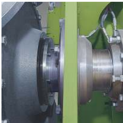
Separados: isolamento e rolamento.
