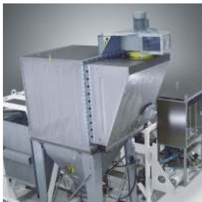
Sistema anti-poeira do misturador.
