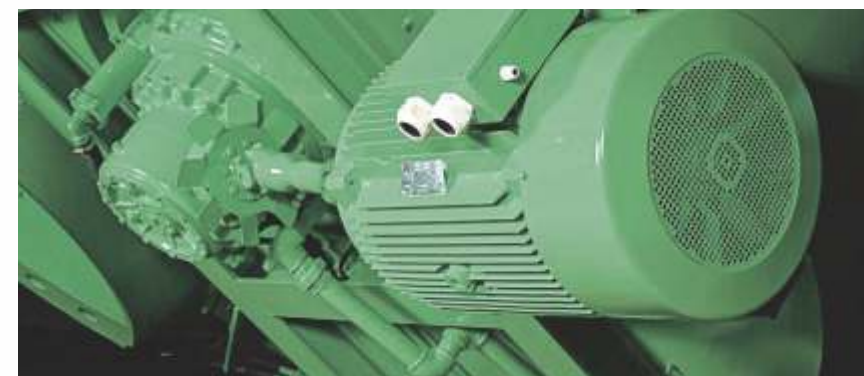
Motor hidráulico planetário e flange montados.
